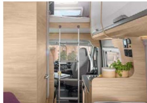
Der Hochdachaufbau ermöglicht ein gigantisches Raumangebot mit einer komfortablen Stehhöhe von bis zu 238 cm. Das leichtgängige Hochdachbett lässt sich mit nur einer Hand herunterfahren und schafft so zwei separate Schlafbereiche. Ideal für Freunde oder Familien.
